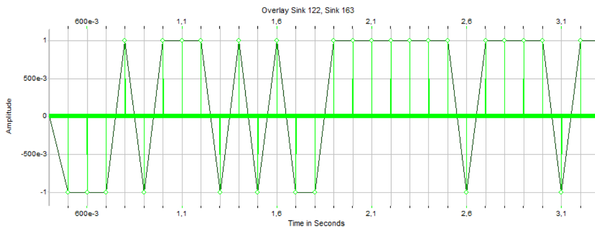
Рис.3.2.3. Реализация на входе системы(черная,эл.1, рис.3.1.1) и последовательность отсчетов на выходе демодулятора (серая, эл.120, рис.3.2.1)
